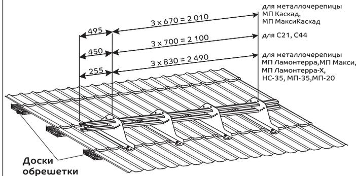
**Внимание!** Снегозадержатели должны быть установлены выше карнизного свеса. Если длина ската кровли превышает приведенную в таблице, нужно устанавливать дополнительный ряд снегозадержателей. Установка кронштейнов снегозадержателей производится строго в низ волны профиля.
