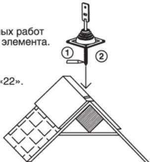
4. Соединить шток с крепёжным элементом при помощи болтов, входящих в комплект поставки.
