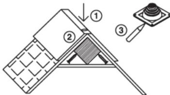
2. В случае, если конёк вентиляционный, надо установить «сухарь» – брус 100x100 мм длиной 200 мм.
